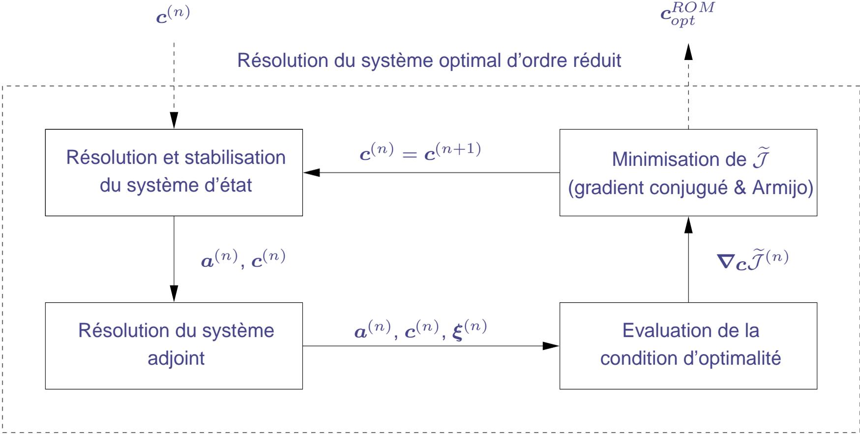
Représentation schématique du processus de résolution du système optimal d'ordre réduit.
