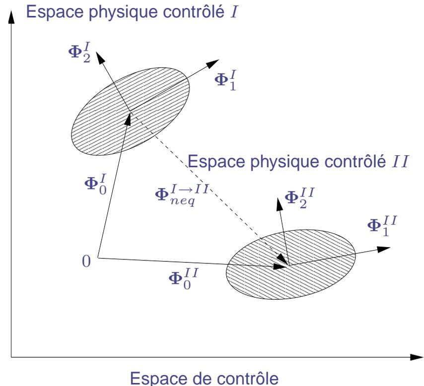
Représentation schématique d'une transition de dynamique par utilisation d'un mode moyen de non-équilibre.
