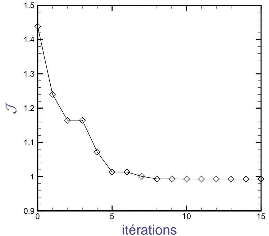
Paramètres de contrôle optimaux :  $A = 4,25$  et  $St = 0,74$
