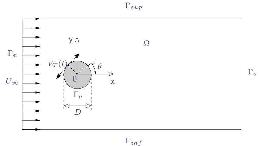
▷ Déterminer les paramètres  $\mathbf{c} = (A, S_t)^T$  qui minimisent le coefficient de traînée moyen
