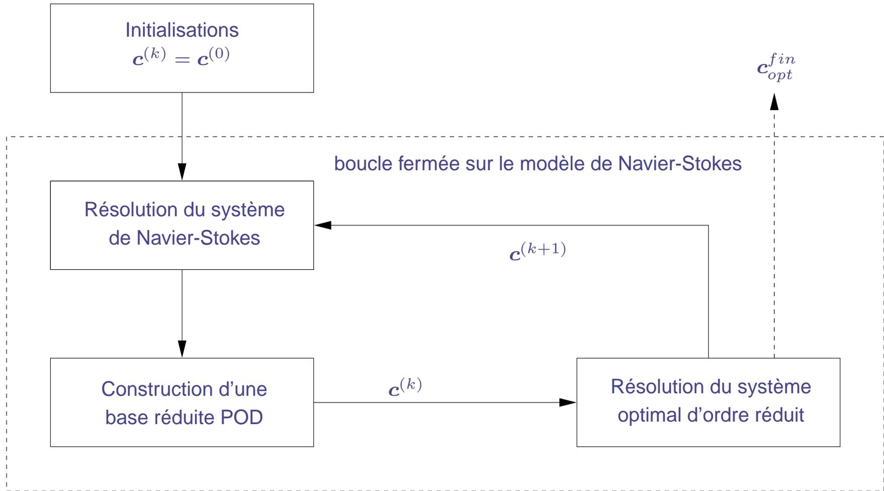
Représentation schématique de la méthode d'optimisation adaptative POD en boucle fermée.
