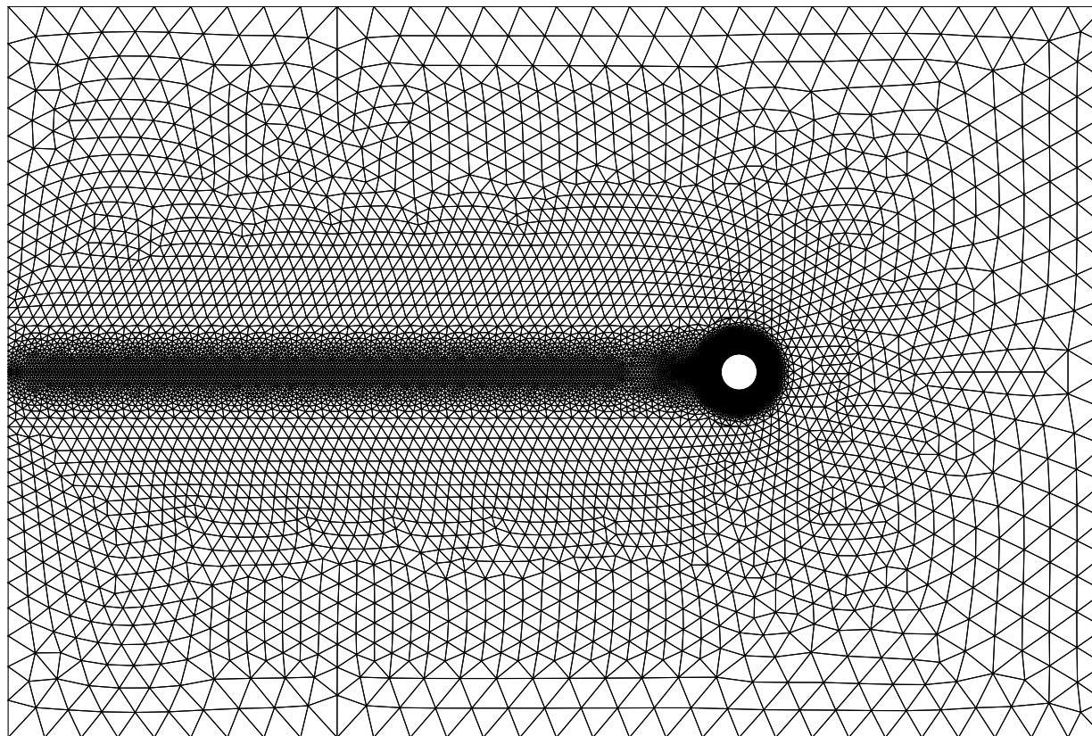
Application: centre de silage d'un cylindre circulaire
