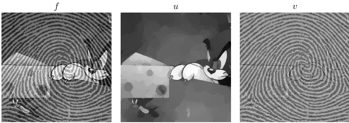
FIG. 9.1 – Image de départ f , composante géométrique extraite u , texture extraite v
