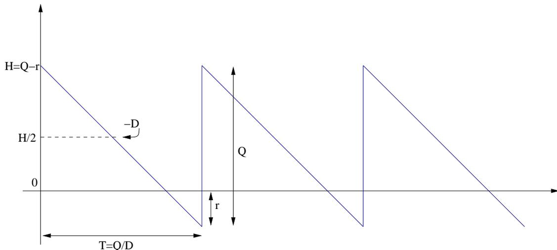
Figure 4: Modèle avec rupture de stock
