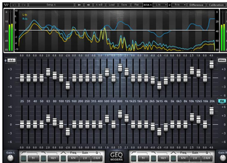
FIGURE 3.9 – Un exemple d'égalisateur graphique. On dit graphique car les fréquences sont ordonnées selon un graphe qui permet de comprendre d'une façon immédiate si la fréquence qu'on change est haute ou basse.
