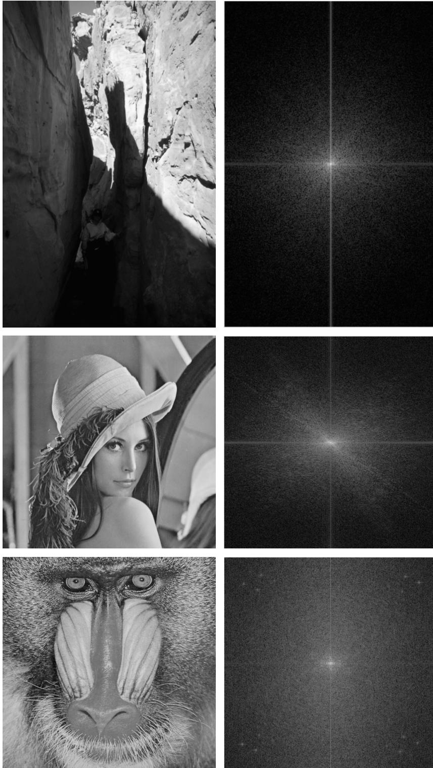
FIGURE 3.14 – Colonne de gauche : images originales. Colonne de droite : spectres d’amplitude centrés des images de gauches, visualisés avec une échelle logarithmique.
