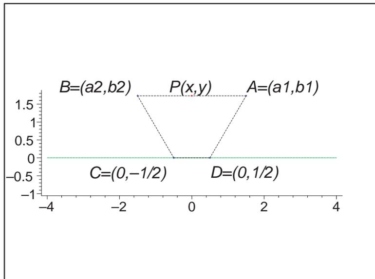
Le deuxième dessin indique quelques positions possibles du système. On suppose qu'un piston soit fixé au point  $B$  afin de mettre le système en mouvement
