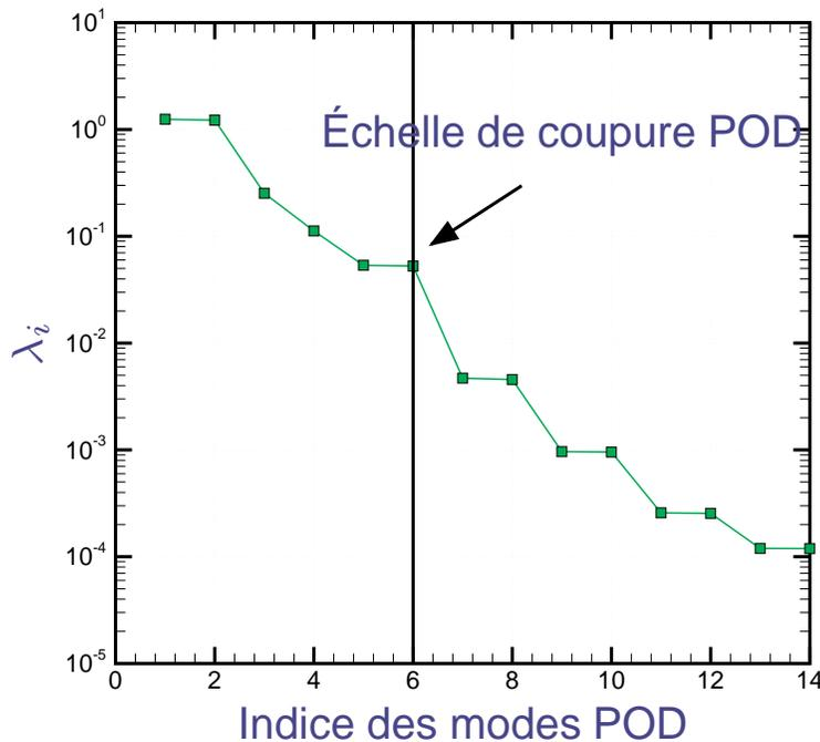
**Fig. :** Spectre énergétique et échelle de coupure POD.
