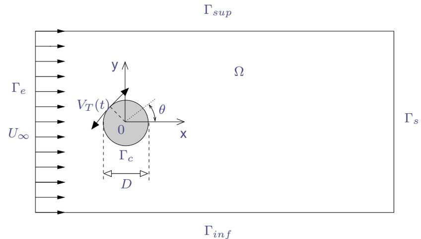
**Déterminer les paramètres  $c = (A, St_f)^T$  qui minimisent le coefficient de traînée moyen**
