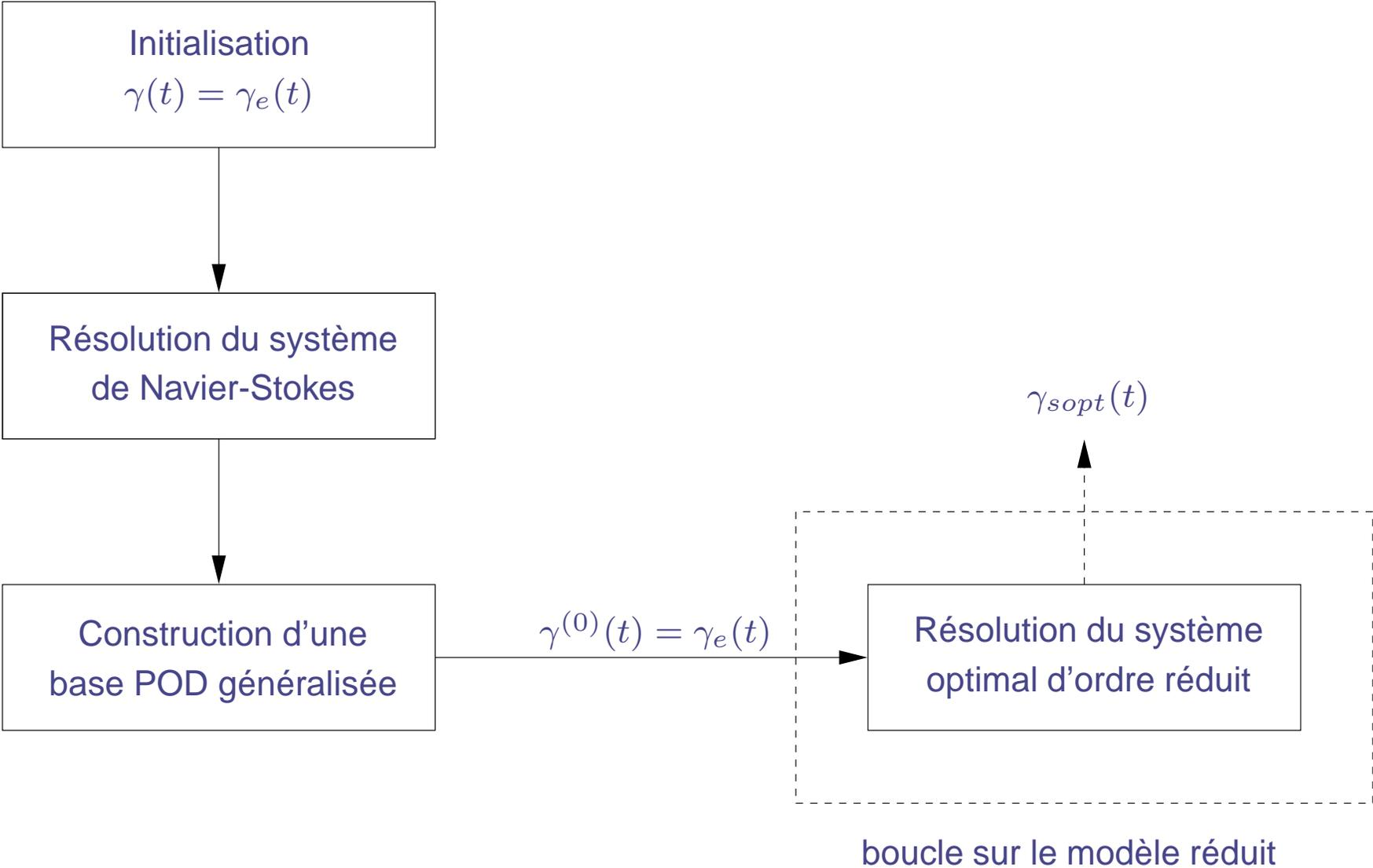
**Fig. :** Représentation schématique de la méthode d'optimisation sans réactualisation de la base POD.
