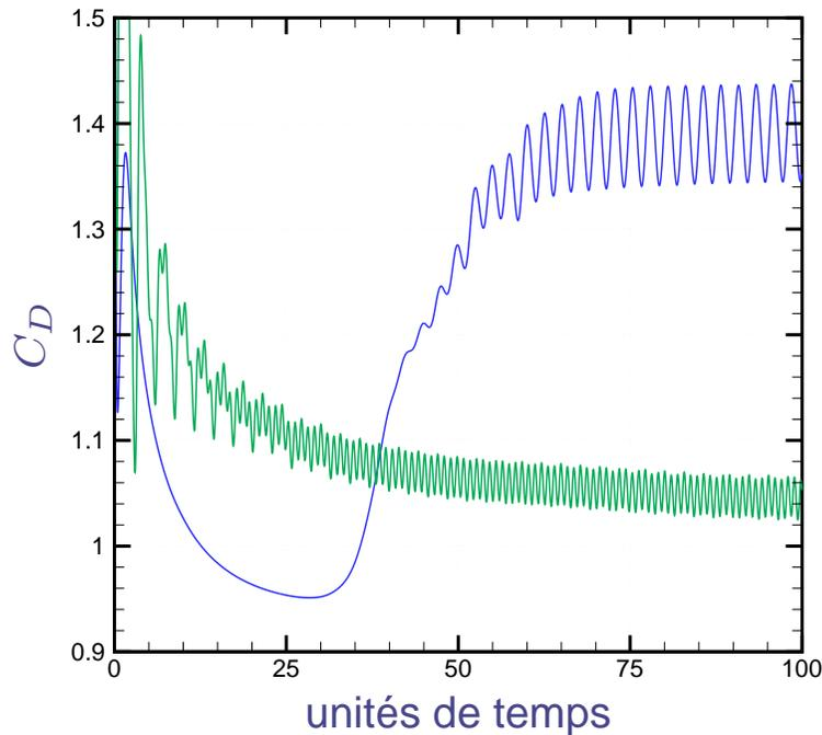
**Fig. :** Comparaison de l'évolution temporelle des coefficients de traînée dans le cas non contrôlé et dans le cas où le contrôle sous-optimal est appliqué.
