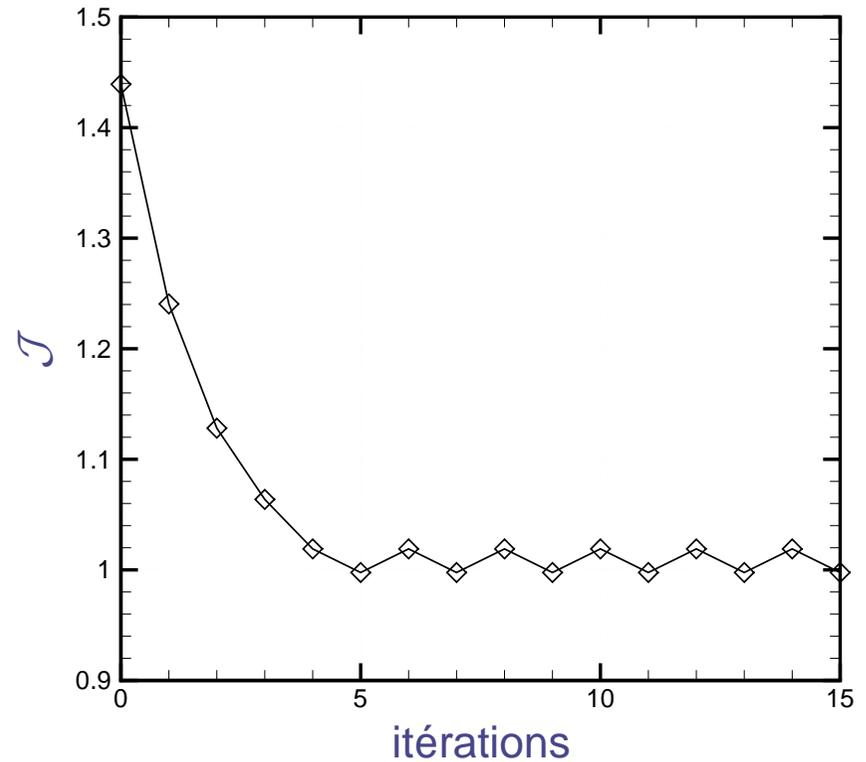
Paramètres de contrôle obtenus : oscillations autour de  $A = 3,25$  et  $St_f = 0,65$
