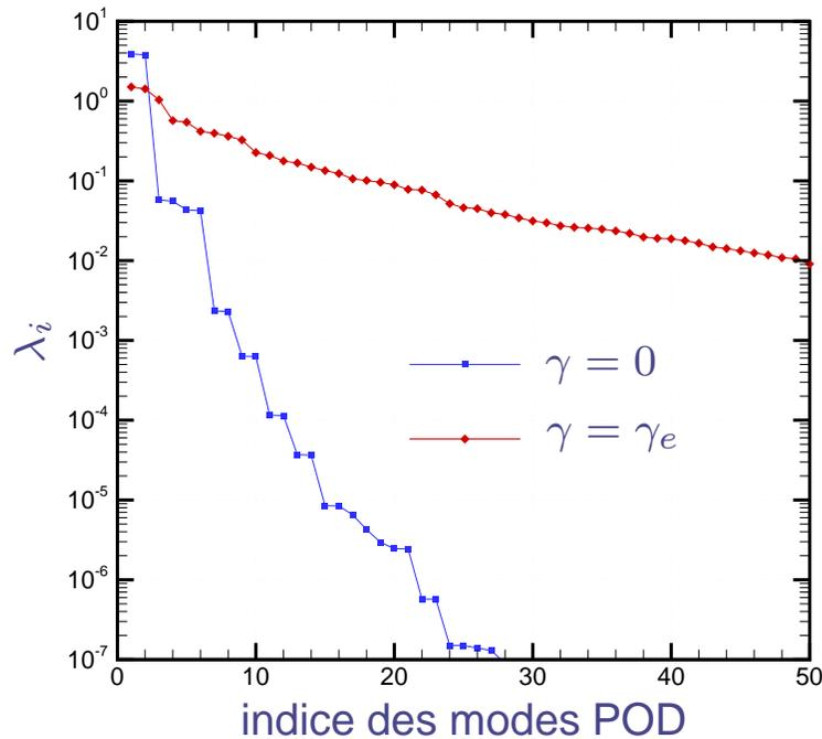
**Fig. :** Comparaison des spectres de valeurs propres pour l'écoulement non contrôlé ( $\gamma = 0$ ) et pour l'écoulement manipulé ( $\gamma = \gamma_e$ ).
