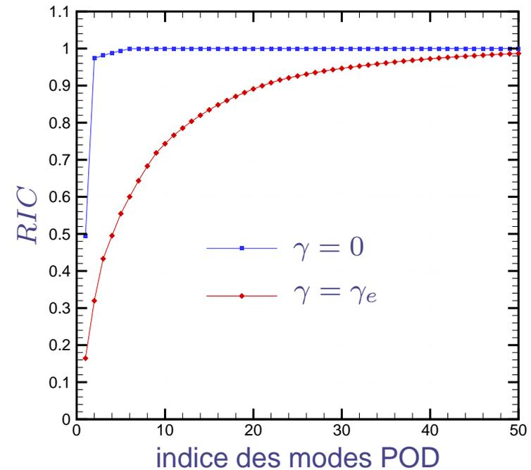
**Fig. :** Comparaison du contenu informationnel relatif pour l'écoulement non contrôlé ( $\gamma = 0$ ) et pour l'écoulement manipulé ( $\gamma = \gamma_e$ ).
