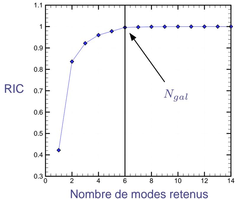
**Fig. :** Énergie cinétique relative en fonction du nombre  $M$  de modes POD retenus.
