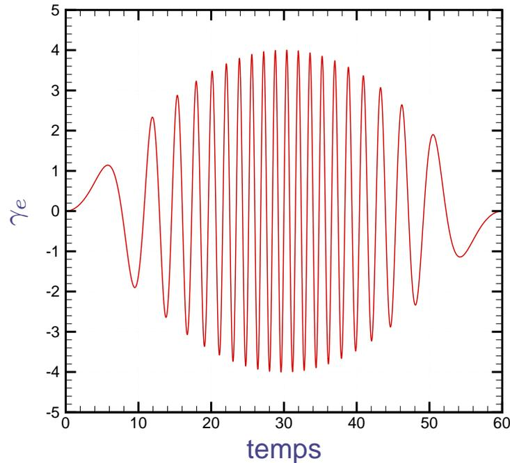
**Fig. :** *Excitation temporelle  $\gamma_e$  imposée au cylindre.*
