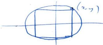
On cherche à maximiser la fonction  $4xy$  sous les contraintes  $\begin{cases} \frac{x^2}{a^2} + \frac{y^2}{b^2} = 1 \\ x \geq 0, y \geq 0 \end{cases}$ .
